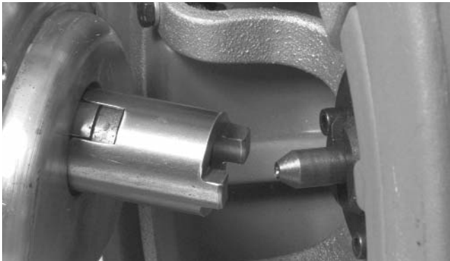
Figure 15 – Tambour K-3800 avec adaptateurs pour K-6200
