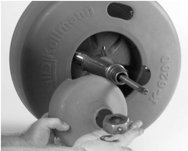
Figura 13 – Extracción del aro de sujeción y del tambor interior
