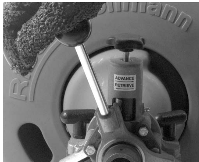
Figure 9 – Fonctionnement du levier d'avancement
