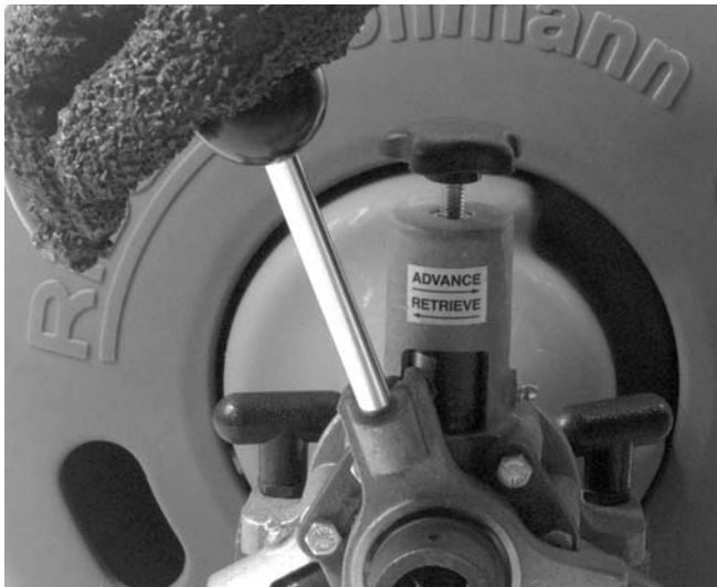
Figura 9 – Funcionamiento de la palanca de autoalimentación
