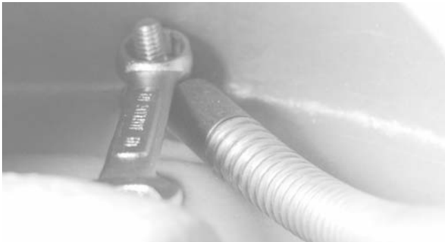
Figura 14 – Extracción del perno de sujeción de la colita de cerdo
