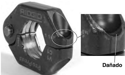
Figura 11 – Cavidad dañada en el aro
