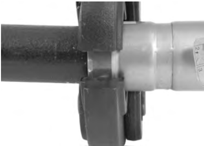
Figure 9 – Mâchoires MegaPress tenues à l'équerre du raccord et du tuyau
