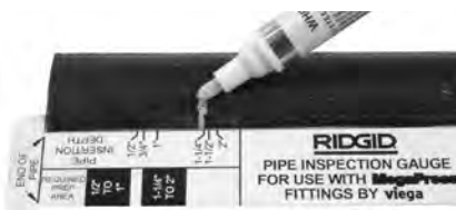
Figure 6B – Repérage de la profondeur d'insertion du tuyau à l'aide d'une jauge de contrôle RIDGID® MegaPress®
