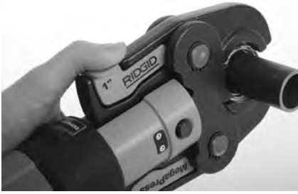
Figure 8 – Ouverture et positionnement des mâchoires MegaPress sur le raccord
