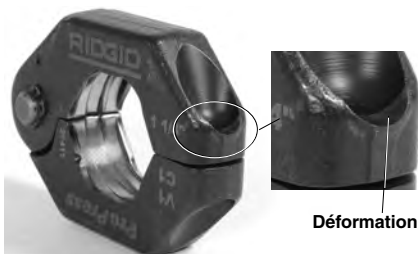
Figure 11 – Déformation au niveau de la dépression de bague
