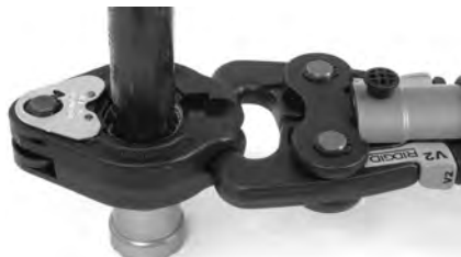
Figure 12A – Engagement des pinces d'actionneur dans les dépressions de bague
