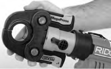
Figure 4 – Retrait d'un outil de sertissage
