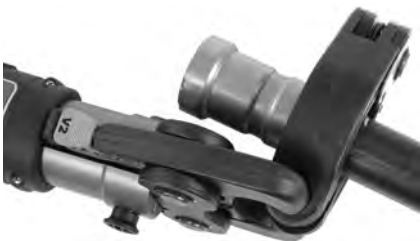
Figura 12B – Colocación del accionador en las cavidades del aro formando un ángulo con el aro para mayor maniobrabilidad
