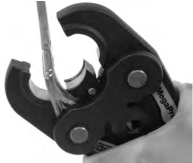
Figura 13 – Limpieza con escobilla de las superficies interiores de una mordaza MegaPress
