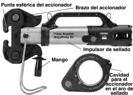
Figura 3 – Aro MegaPress XL, impulsor de sellado y accionador Z3
