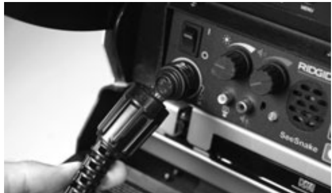
Figura 23 – Alineamiento del enchufe macho del cable del sistema
