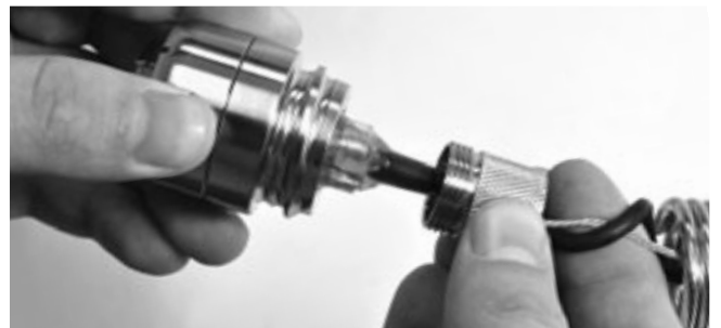
Figura 37 – Extracción de la cámara fuera de la manga de retención
