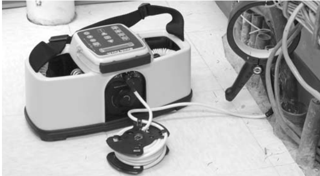
Figura 12 – Pinza inductiva ceñida a un conductor
