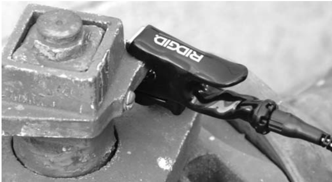
Figura 8 – Conexión de uno de los cables de conexión al conductor-objetivo
