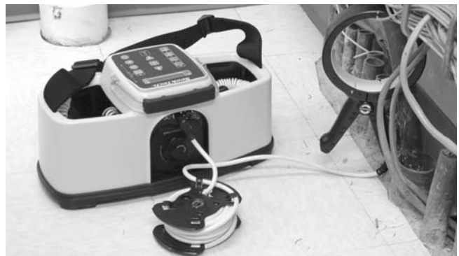
Figure 12 – Pince à induction autour du conducteur
