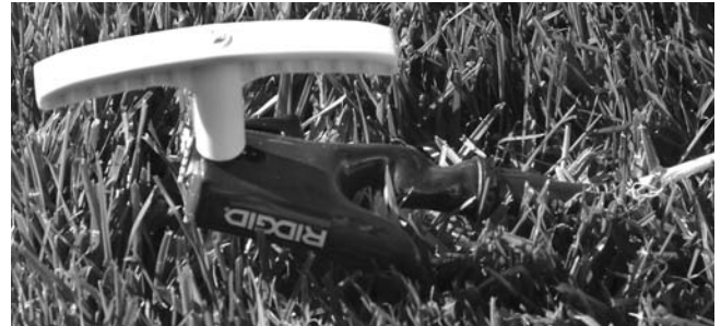
Figura 7 – Acoplo de uno de los cables de conexión a la estaca de puesta a tierra
