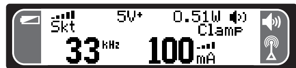
Figure 11 – Transmetteur en mode « induction »
