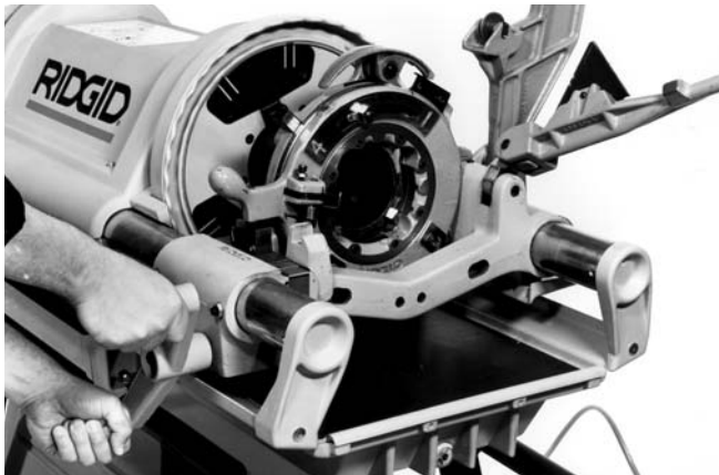
Figure 15 – Filetage NPT/BSPT avec tête de filière N° 714 ou N° 914
