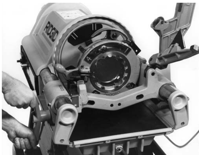
Figura 17 – Roscado de roscas NPSM/BSPP con cabezales de terraja no. 714 o 914
