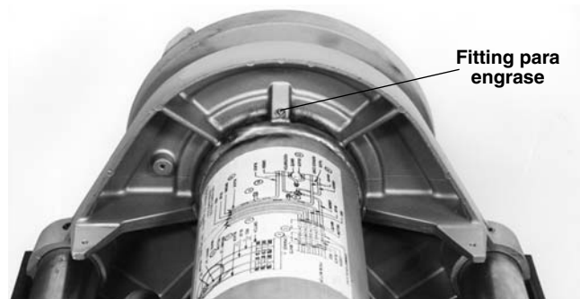
Figura 31 – Engrase de los cojinetes del eje principal
