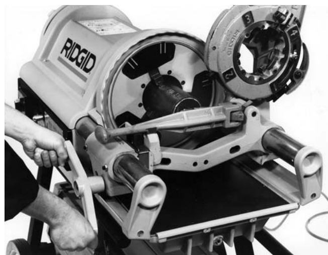
Figura 7 – Escariado de tubos con la Escariadora No. 744
