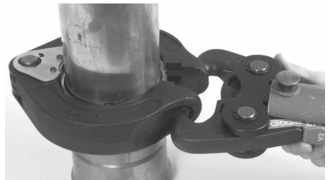
Figura 14B – Las puntas del accionador V2 asentadas en las cavidades del aro XL-C
