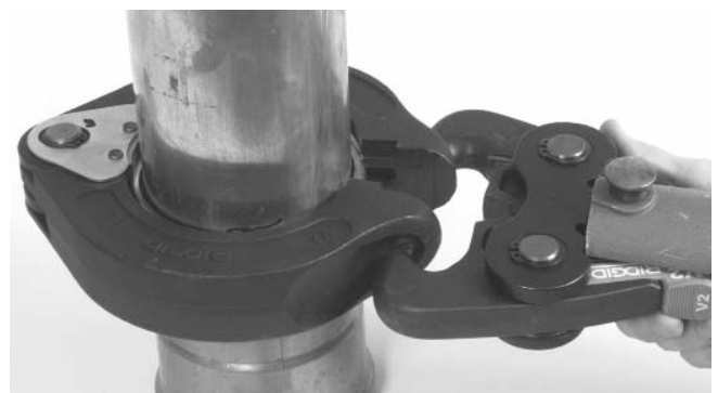
Figure 14B – Positionnement des embouts d'actionneur V2 dans les logements de bague XL-C
